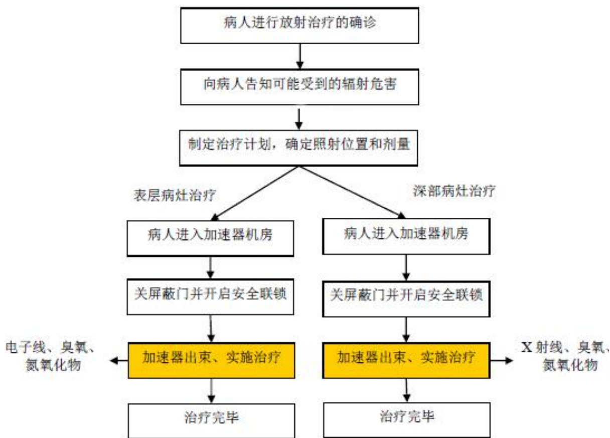
图 9-7 医用直线加速器的作业流程及产污环节示意图
